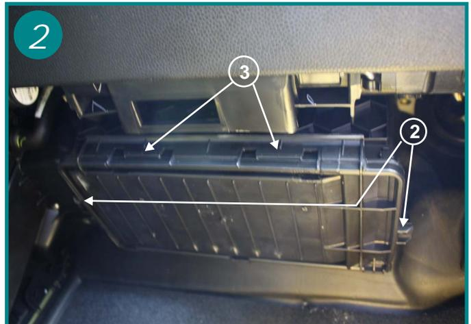
Pour retirer le couvercle, il faut tout d'abord retirer les 2 vis (2) (attention certains véhicules ne sont pas équipés de ces vis), puis faire sortir légèrement les 2 pattes (3) afin de basculer le couvercle vers le bas ce couvercle est muni d'une charnière derrière.
