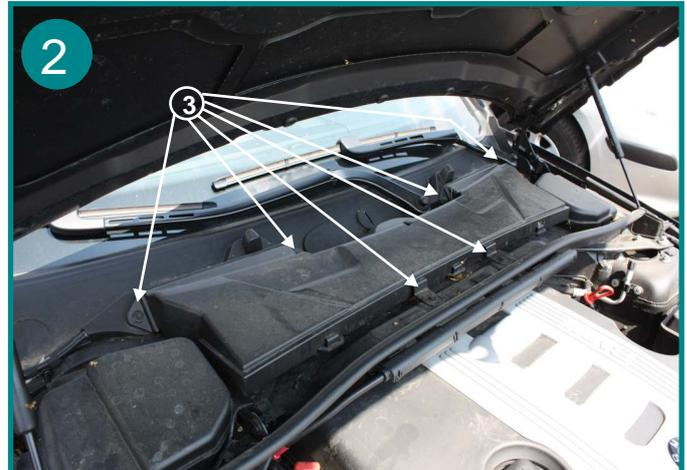
Dévisser les 6 vis de 8 du boîtier filtrant (2), le sortir et le retourner.
