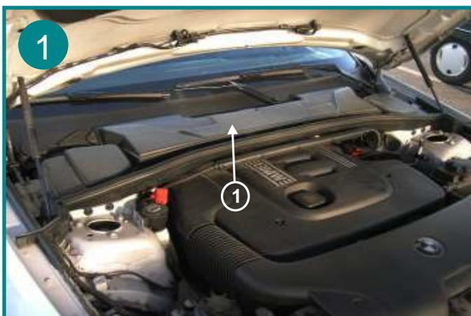
Le filtre d'habitacle est situé sous le capot moteur, sous la baie de pare-brise au centre (voir repère 1). Ouvrir le capot moteur,
