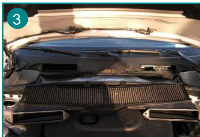
Sortir le filtre usagé de son boîtier et le remplacer
