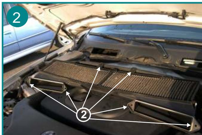
Dévisser les 6 vis de fixation du boîtier de filtre (repère 2), puis soulever l'ensemble et le retourner pour avoir accès au filtre
