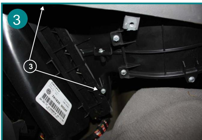
Dévisser les 2 vis (M5,5) qui fixe le couvercle du boîtier filtrant et le retirer (3).
