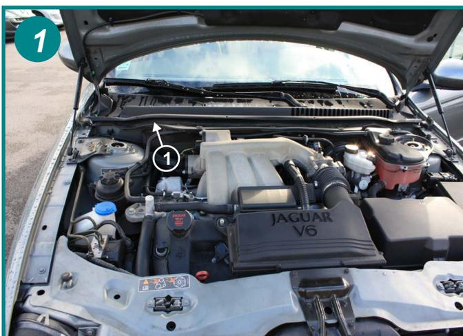
Le filtre d'habitacle est situé sous le capot moteur, côté passager sous la baie de pare brise (1).
