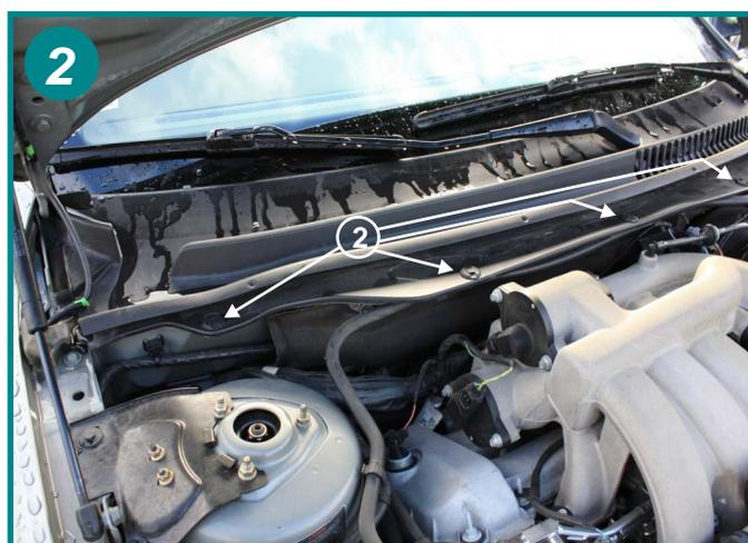
Retirer les 4 clips plastiques (2), à l'aide d'un tournevis plat soulever la partie centrale de chaque clips et les sortir.
