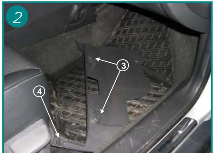
Dévisser les 2 vis torx (flèche 3) et déclipper le bord du cache plastique (voir flèche 4). Retirer le cache plastique.
