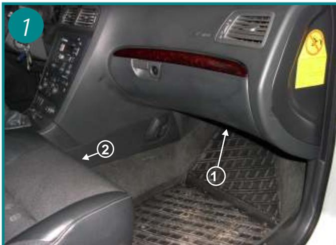
L'élément filtrant est situé dans l'habitacle du véhicule sous la boîte à gants (voir flèche 1). Retirer le cache plastique du bas de la console centrale en dévissant la vis plastique d'un quart de tour situé sous le siège (voir flèche 2).
