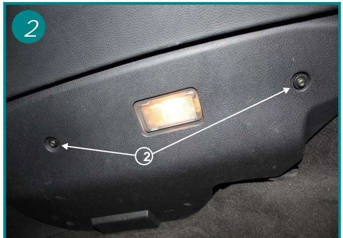
Dévisser les 2 vis Torx T30 qui maintiennent le carter rigide sous la boîte à gants (2), pour le retirer, sortir le côté droit en premier puis dégager-le dans sa totalité (attention ce carter est équipé d'une partie retombante sur la console centrale).
