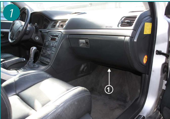
Le filtre d'habitacle est situé sous la boîte à gants, côté passager à l'intérieur du véhicule (1).
