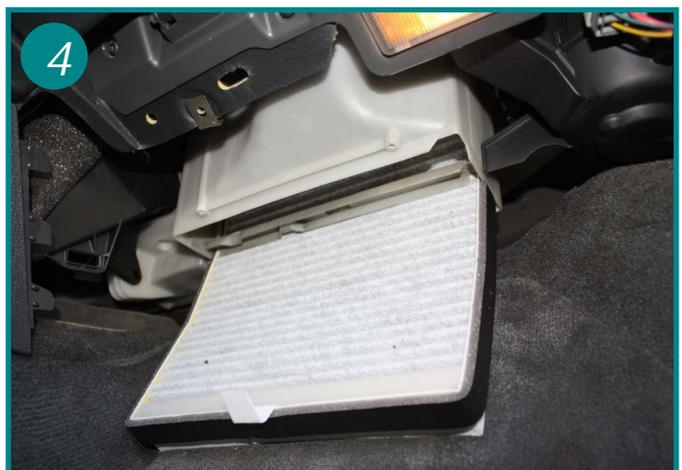
Extraire le filtre usagé par le bas en le pliant légèrement et le remplacer.
