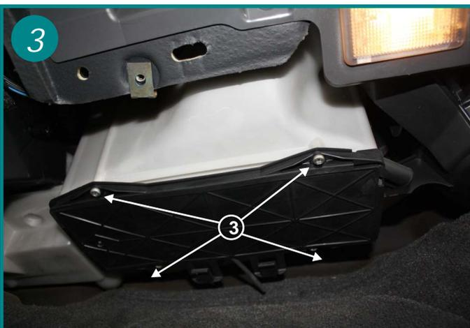
Dévisser les 4 vis Torx T30 du couvercle du boîtier filtrant (3) et le retirer, faire attention au joint d'étanchéité autour de ce couvercle
