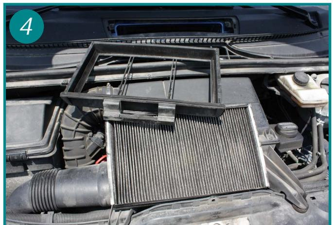
Sortir l'élément filtrant de son cadre et le remplacer. Le remontage s'effectue dans l'ordre inverse du démontage.
