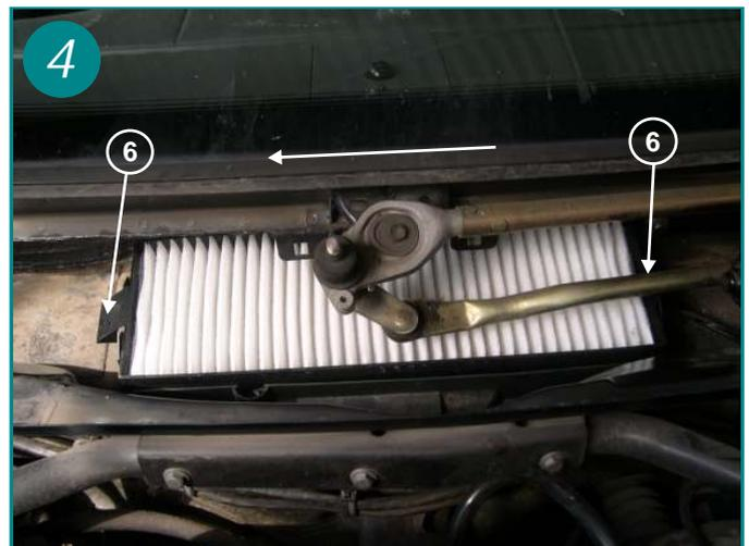
Procéder au changement de celui-ci en le faisant coulisser dans le sens de la flèche, replacer les 2 vis de fixation (repère 6). Le remontage s'effectue dans l'ordre inverse du démontage.
