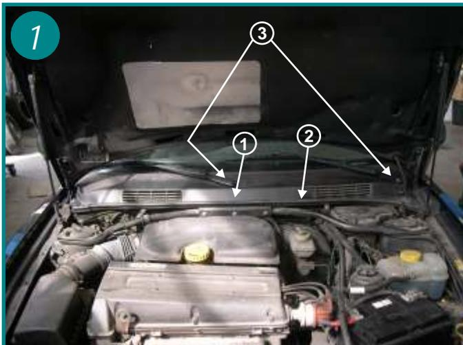
Le filtre d'habitacle est situé sous le capot moteur, sous la baie de pare-brise au centre (repère 1). Retirer le joint d'étanchéité (repère 2), puis dévisser et extraire les balais d'essuie-glace (repère 3).
