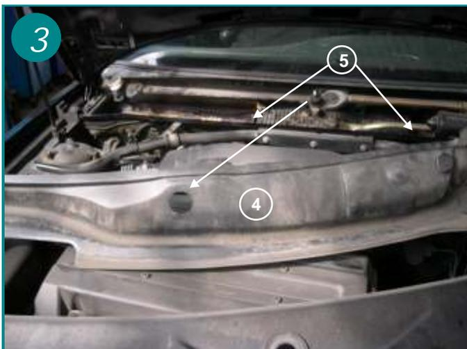
Retirer le carter de protection situé au dessus des mécanismes d'essuie-glace (repère 4) aucun outil n'est nécessaire pour le démonter. Dévisser les 2 vis de maintien du filtre d'habitacle (5)
