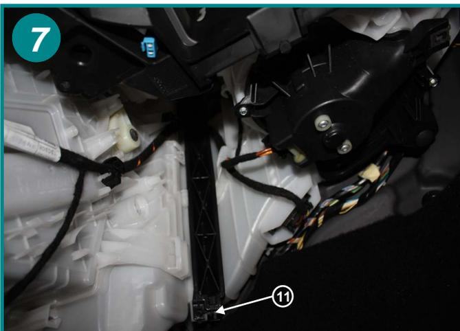
Ouvrir le boîtier filtrant en retirant le couvercle par le bas (11).
