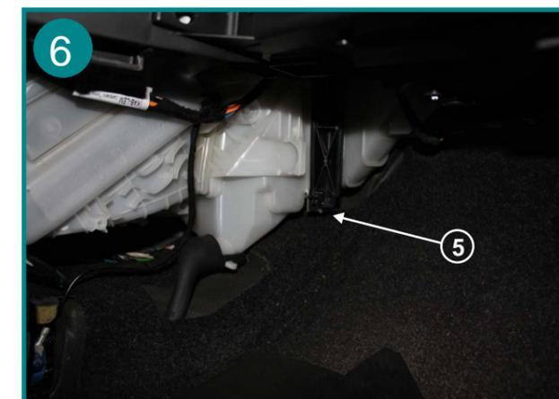
Retirer le couvercle du boîtier en agissant par le dessous (5) à l'aide de la patte d'ouverture.
