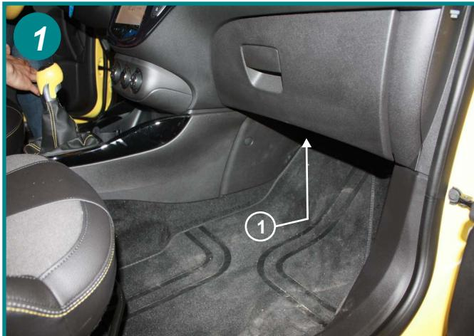
Le filtre d 'habitacle est situé à l 'intérieur du véhicule, coté passager sous la boîte à gants côté console (1).
