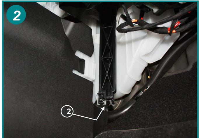
Ouvrir le boîtier filtrant en tirant sur le couvercle par le bas (2), attention il est maintenu également en haut, une fois dégagé du bas, le soulever légèrement afin de le sortir totalement.
