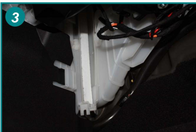
Extraire l 'élément filtrant usagé et le remplacer, re-positionner le couvercle par le haut tout d 'abord et le ré-encliquer ensuite en bas.
