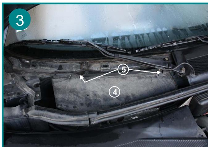
Retirer ensuite le cache protecteur (4) il n'est pas fixé juste positionné sur l'arrière par 2 pattes (5) et devant à l'emplacement des 2 vis retirées précédemment.
