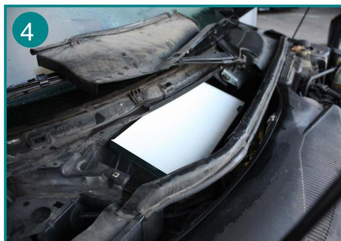
Extraire l'élément filtrant usagé de son cadre plastique et le remplacer, 2 pattes (6) le maintiennent en place. Le remontage s'effectue dans l'ordre inverse du démontage.
