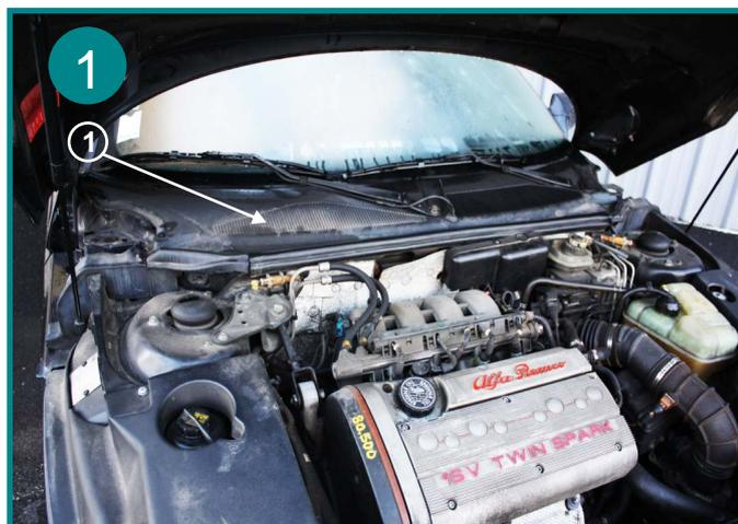
Le Filtre habitacle est situé sous le capot moteur, coté passager devant la baie de pare-brise (1). Ouvrir le capot moteur.
