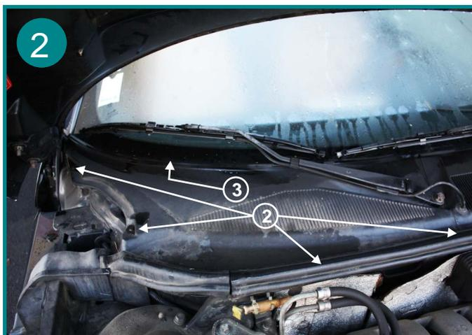
Dévisser les quatre vis Torx (T20) (2) et extraire le carter de ventilation dans sa totalité. Attention au joint lèvres (3), il est souvent collé au pare-brise et peut se détériorer au démontage.
