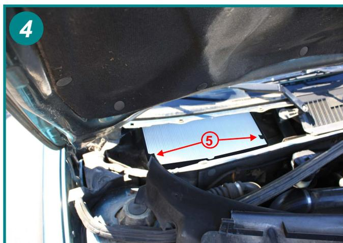
Soulever les 2 pattes de fermeture (5), extraire le filtre usagé et procéder à son remplacement. Le remontage s'effectue dans l'ordre inverse du démontage.
