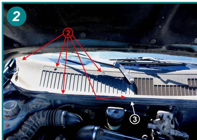
Dévisser les 5 vis cruciformes (2), retirer en partie le joint d'étanchéité (3) et extraire le carter plastique dans sa totalité, il n'est pas nécessaire de retirer le balai d'essuie-glace.
