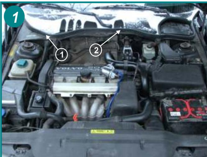
Le filtre d'habitacle est situé sous le capot moteur, coté passager sous la baie de pare-brise (1). Ouvrir le capot moteur, retirer le joint d'étanchéité moteur (2).
