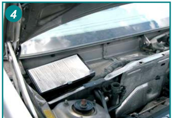
Sortir l'élément filtrant usagé de son cadre et le remplacer. Le remontage s'effectue dans l'ordre inverse du démontage.
