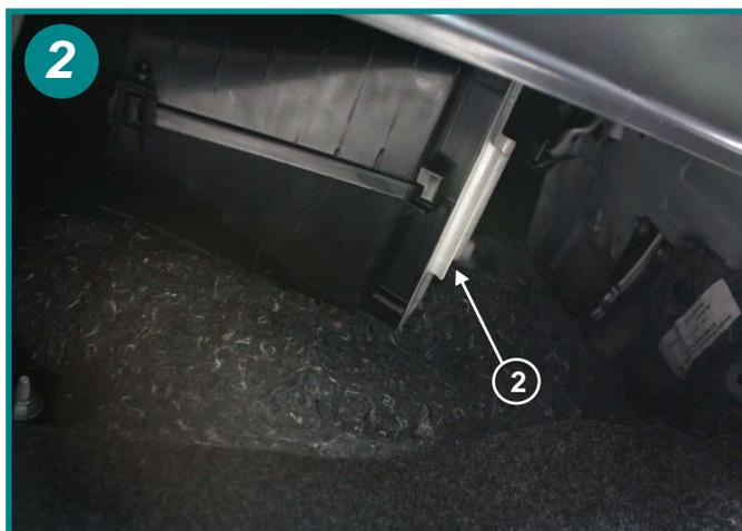
Exercer une pression sur les pattes du couvercle (2) et tirer vers le bas pour déloger le filtre.
