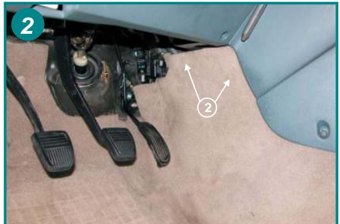
Dégrafer (2) le flanc souple de la console centrale et retirer totalement ce carter.
