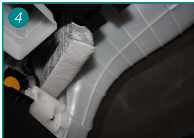
Extraire les 2 éléments filtrants usagés, placés l'un au dessus de l'autre à l'aide des languettes prévues. Procéder au changement en mettant les languettes sur le devant. Le remontage s'effectue dans l'ordre inverse du démontage.
