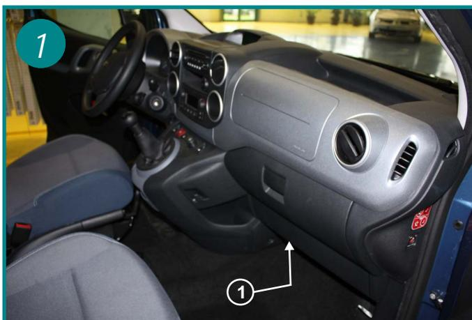
Les filtres d'habitacle sont situés à l'intérieur du véhicule côté passager sous la boîte à gants (1).
