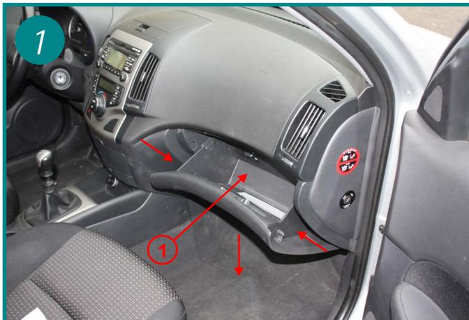
Le filtre d'habitacle est situé à l'intérieur du véhicule coté passager derrière la boîte à gants (1).
