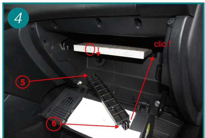
Sortir le filtre usagé, le remplacer (flèche vers le bas) replacer le couvercle du boîtier en positionnant tout d'abord la patte à l'extrémité (5) et en cliquant l'autre extrémité (6). Le remontage s'effectue dans l'ordre inverse du démontage.
