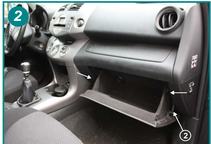
Ouvrir la boîte à gants, appuyer sur les fangs du tiroir afin de dégager les arrêtoirs (voir flèche) et retirer le vérin de retenue (2).
