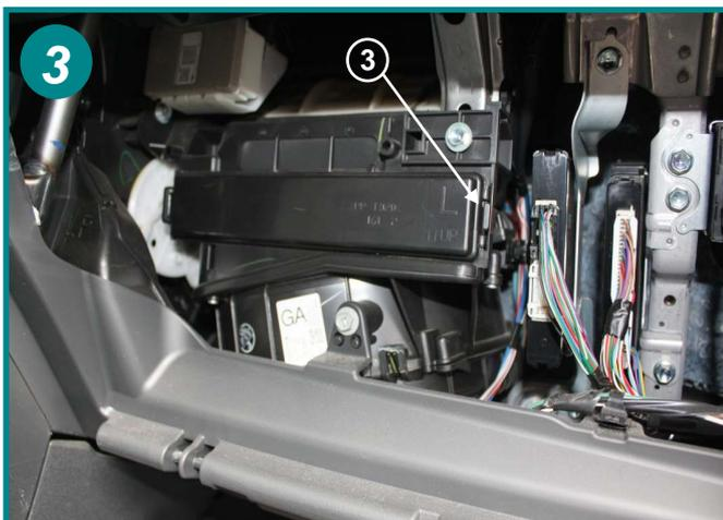
Ouvrir le couvercle articulé du boîtier filtrant à l'aide du fermoir situé sur la droite (3).
