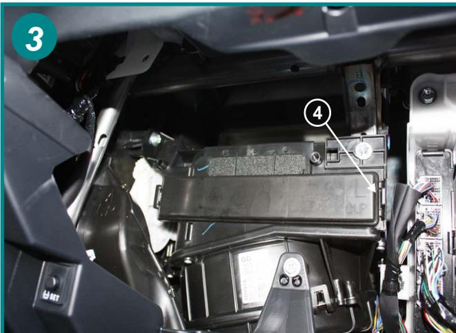
Ouvrir le boîtier filtrant à l'aide du fermoir situé à droite du couvercle (4), ce couvercle étant articulé à gauche. Retirer le couvercle.
