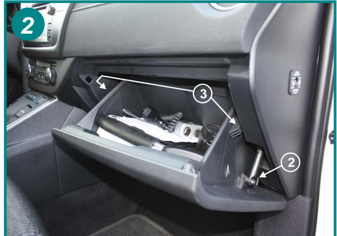
Désaccoupler l'amortisseur d'ouverture de boîte (2), puis presser sur les flancs du tiroir pour dégager les arrêtoirs (3), basculer le tiroir vers le bas pour le désolidariser et le retirer totalement.
