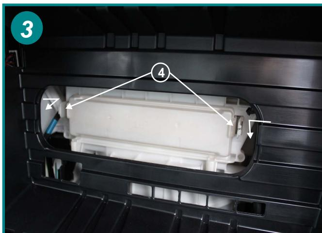
Ouvrir le boîtier filtrant en actionnant les tirettes dans le sens des flèches à gauche et à droite du couvercle (4).
