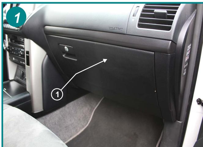
L'élément filtrant est situé à l'intérieur du véhicule, côté passager derrière la boîte à gants (1).
