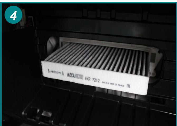
Retirer l'élément filtrant usagé et glisser un nouvel élément dans le logement.
