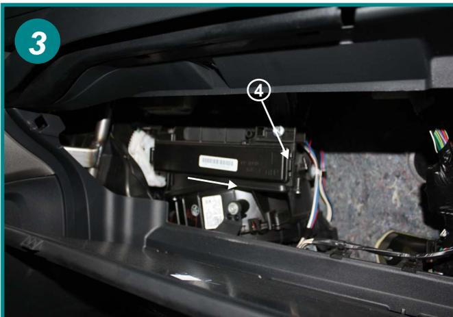
Ouvrir le couvercle du boîtier filtrant (4) par la droite et retirer le.
