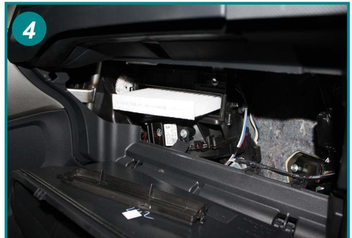
Sortir l'élément filtrant usagé de son logement et procéder à son remplacement. Le remontage s'effectue dans l'ordre inverse du démontage.
