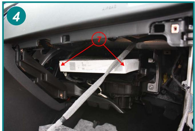
Retirer le filtre usagé et remplacer-le en veillant à positionner les 2 rabats vers le haut (7). Le remontage s'effectue dans l'ordre inverse du démontage.
