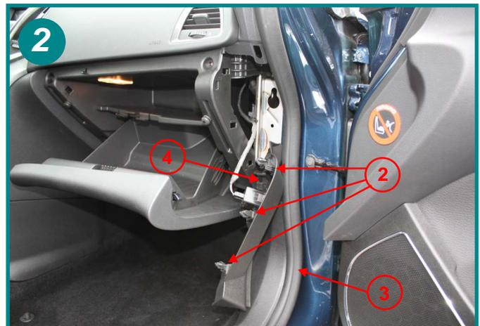
Démonter le flanc droit de la planche de bord en exerçant une pression assez forte (clips métalliques) (2) ne pas débrancher la commande de l'air-bag. Retirer le flanc en écartant le joint de portière (3) Dévisser la 4ème vis de fixation (4).
