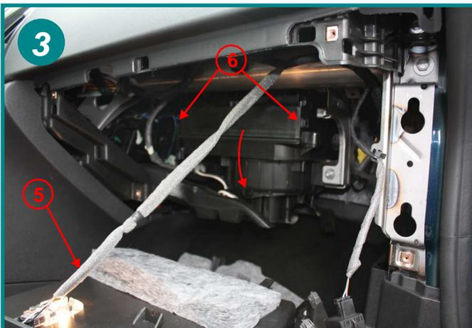
Sortir le bloc boîte à gants dans sa totalité, il n'est pas nécessaire de débrancher l'éclairage (5). Le boîtier de filtre est alors visible, actionner les 2 fermetures du couvercle (6) et basculer celui-ci vers le bas (voir flèche).
