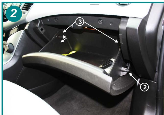
Ouvrir la boîte à gants, débrancher l'amortisseur de descente de boîte (2), dégager les 2 arrêtoirs (3) en procédant dans le sens des flèches. Basculer le tiroir vers le bas.
