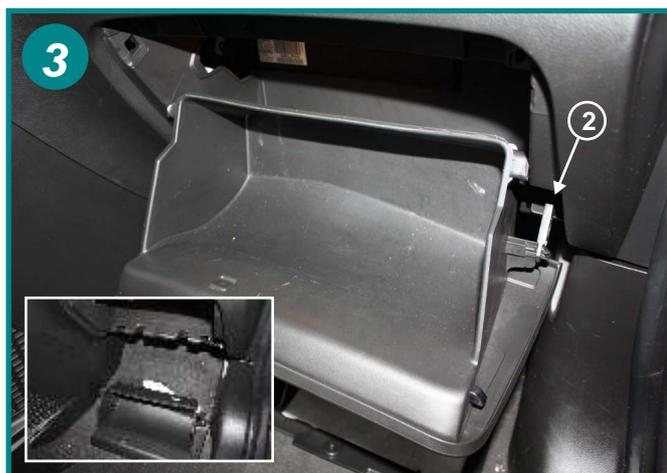
Débrancher l'amortisseur de retenue (2) et sortir le bloc boîte à gants dans sa totalité et le déposer au sol (voir encadré).
