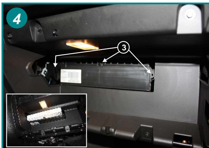
Ouvrir les 3 fermoirs plastiques (3) et basculer le couvercle vers le bas. Extraire l'élément filtrant usagé et le remplacer (voir encadré). Le remontage s'effectue dans le sens inverse du démontage.
