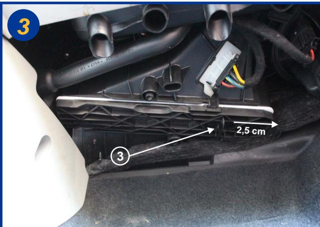
Pour ouvrir le boîtier filtrant, s'aider de la poignée (3) et faire coulisser le couvercle dans le sens de la flèche d'environ 2,5 cm.
