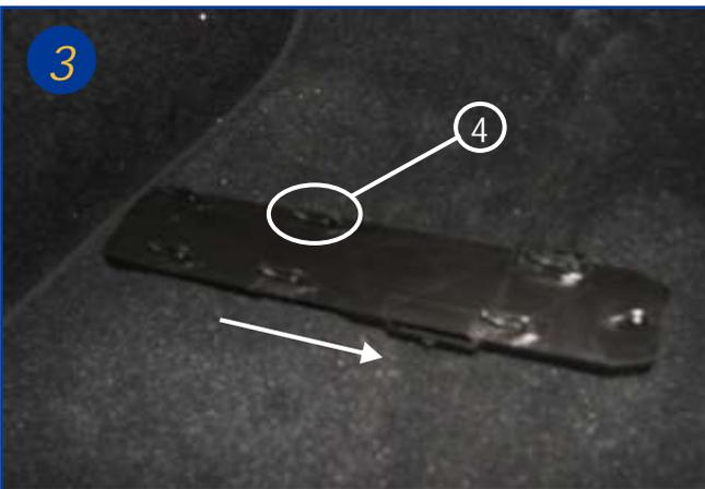
Après avoir localisé le boîtier filtrant, faire coulisser le couvercle de fermeture d'environ 20 mm dans le sens de la flèche et retirez-le
