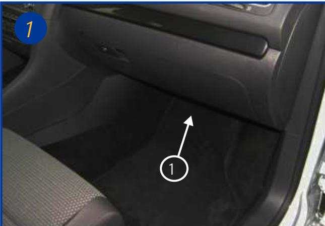
Le boîtier filtrant est situé à l'intérieur du véhicule sous la boîte à gants, coté passager (voir flèche 1)
