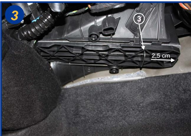
Ouvrir le boîtier filtrant en faisant coulisser le couvercle vers la droite d'environ 2,5 cm pour dégager les ergots à l'aide de la poignée (3).
