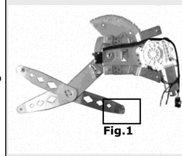
Alzacristallo originale – oem window regulator – lève-vitre original – Fernsterheber von oem – elevalunas original – levantador de vidro original – oriinal cam acacagi - Γρύλος γνήσιος
