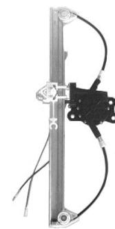
Alzacristallo originale – oem window regulator – lève-vitre original – Fernsterheber von oem – elevvalunas original – levandator de vidro original – nosso elevador de vidro - bizim cam orijinal cam acacagi - Γρύλος γνήσιος
