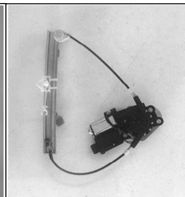
Alzacristallo originale – oem window regulator – lève-vitre original – Fernsterheber von oem – elevalunas original – levandator de vidro original · oriinal cam acacagi - Γρύλος γνήσιος
