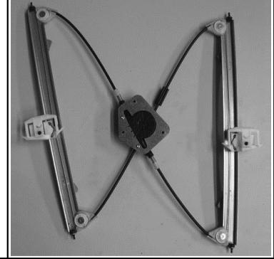
Alzacristallo originale – oem window regulator – lève-vitre original – Fernsterheber von oem – elevalunas original – levandator de vidro original – orijinal cam acacagi – Γρύλος γνήσιος
