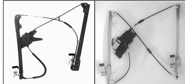
Alzacristallo originale – oem window regulator – lève-vitre original – Fernsterheber von oem – elevalunas original – levandator de vidro original orijinal cam acacagi - Γρύλος γνήσιος
