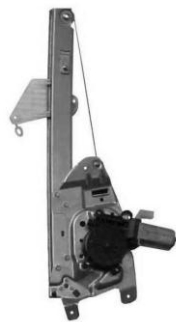
Alzacristallo originale – oem window regulator – lève-vitre original – Fensterheber von oem – elevalunas original – levandator de vidro original – orijinal cam acacagi – Γρύλος γνήσιος
