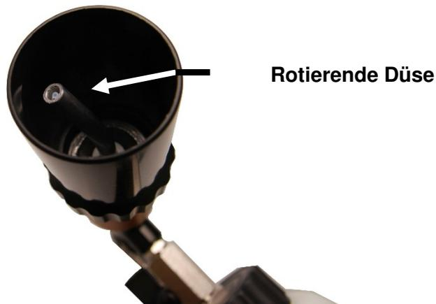
5. Drücken Sie den Auslöser und bewegen Sie die Druckluft-Reinigungspistole langsam in kreisenden Bewegungen über die zu reinigende Oberfläche.
