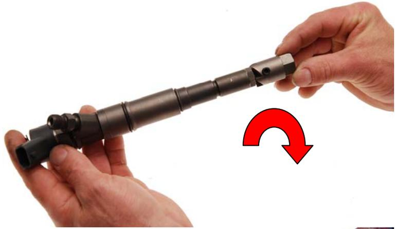
Fräser in den Injektorschacht einführen und die Dichtfläche im Zylinderkopf durch Drehen des Fräasers reinigen (siehe Abbildung).
