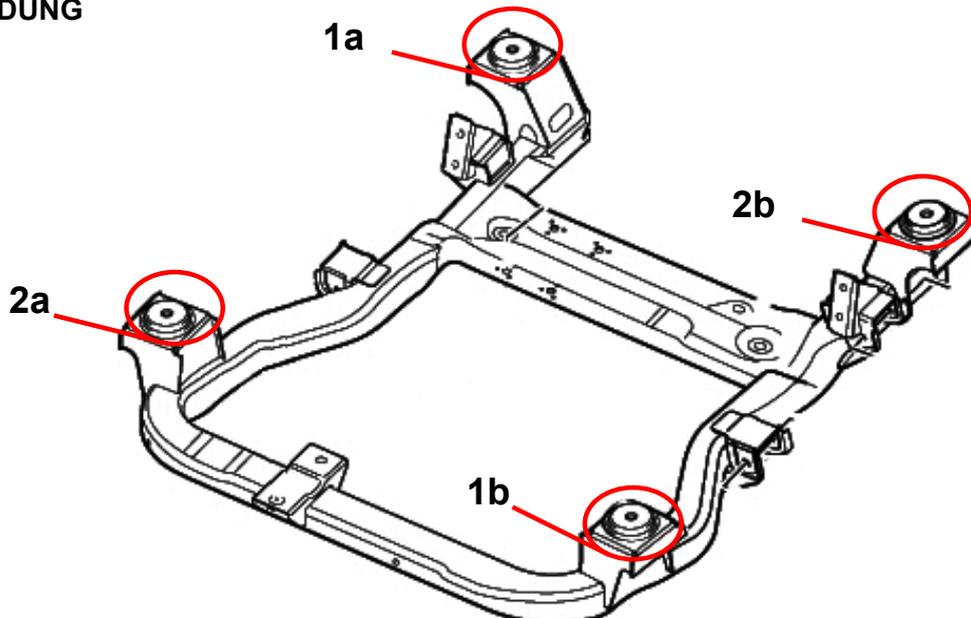
Zur Justierung des Aggregate-Rahmens müssen an den gekennzeichneten Positionen in 2 Schritten die gegenüberliegenden Schrauben nacheinander gegen die Justierbolzen ausgetauscht werden. Die Justierbolzen mit einem Drehmoment von maximal 20 Nm anziehen, da sonst das Gewinde der Justierbolzen beschädigt wird.
