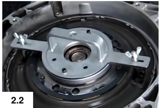
3. Kupplungseinheit durch schlagartiges Drehen gegen den Uhrzeigersinn lösen.
