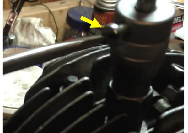
Kurbelwelle eine halbe Umdrehung gegen die Drehrichtung drehen.
